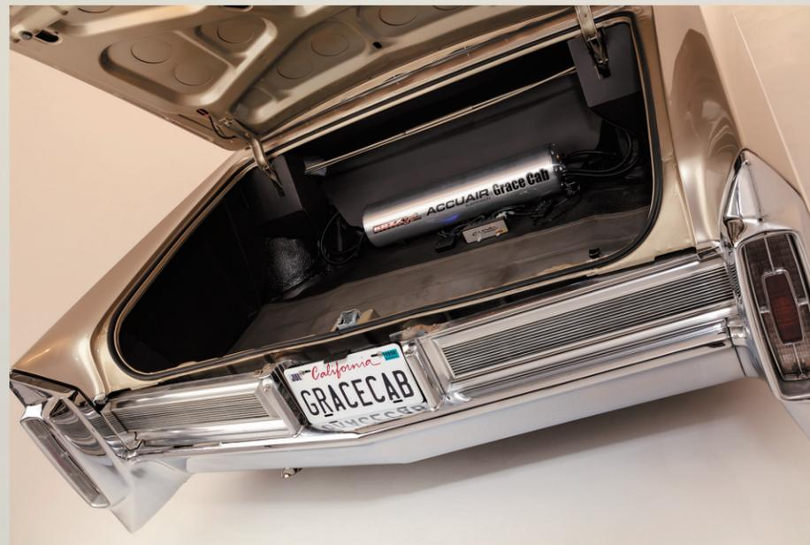
トランク内は現在のところ暫定として ACCUAIR の ENDO CVT タンクをレイアウト。コントロールはもちろん E-LEVEL システムを採用。文字通り最新のシステムを搭載している。今後はパイピングも含めたセットアップを予定しているとのことだ。近年の車両とは全く異なるこのトランクスペースもまた、この年代のキャデラックらしい部分でもある。
