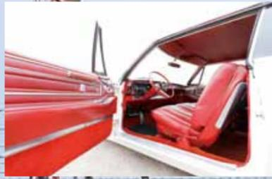
セダンやコンバーチブルモデルも存在するが、撮影車両は2ドアクーペモデル。全長は5690mm。車幅は2mを超える。2輪独立ハイスピードエアサスを搭載し、社外の20インチホイールを装着。
