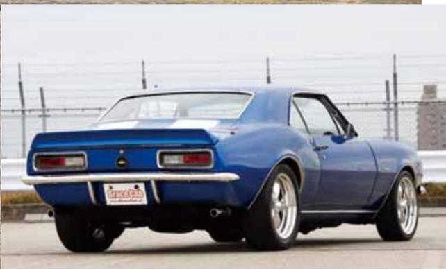
67年型を語る上で外せないのがやはり三角窓。67だけの装備であり、マニアは必ず注目する部分だ。グリルのヘッドライト内側のパーキングランプは丸形なのも67の特徴だ。ホイールはアメリカンレーシングの18インチに変更されている。ボディの状態は間違いなく高いレベルにある。
